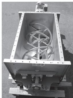
Figura 3.7. Componente interno de um misturador de banda helicoidal<sup>6</sup>.
