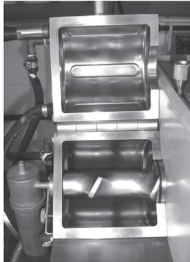
Figura 3.9 – Detalhe da câmara de mistura e do rotor de um misturador de alta rotação usado para preparar concentrados de PVC. Notar as mangueiras para refrigeração da câmara de mistura localizadas do lado esquerdo.
